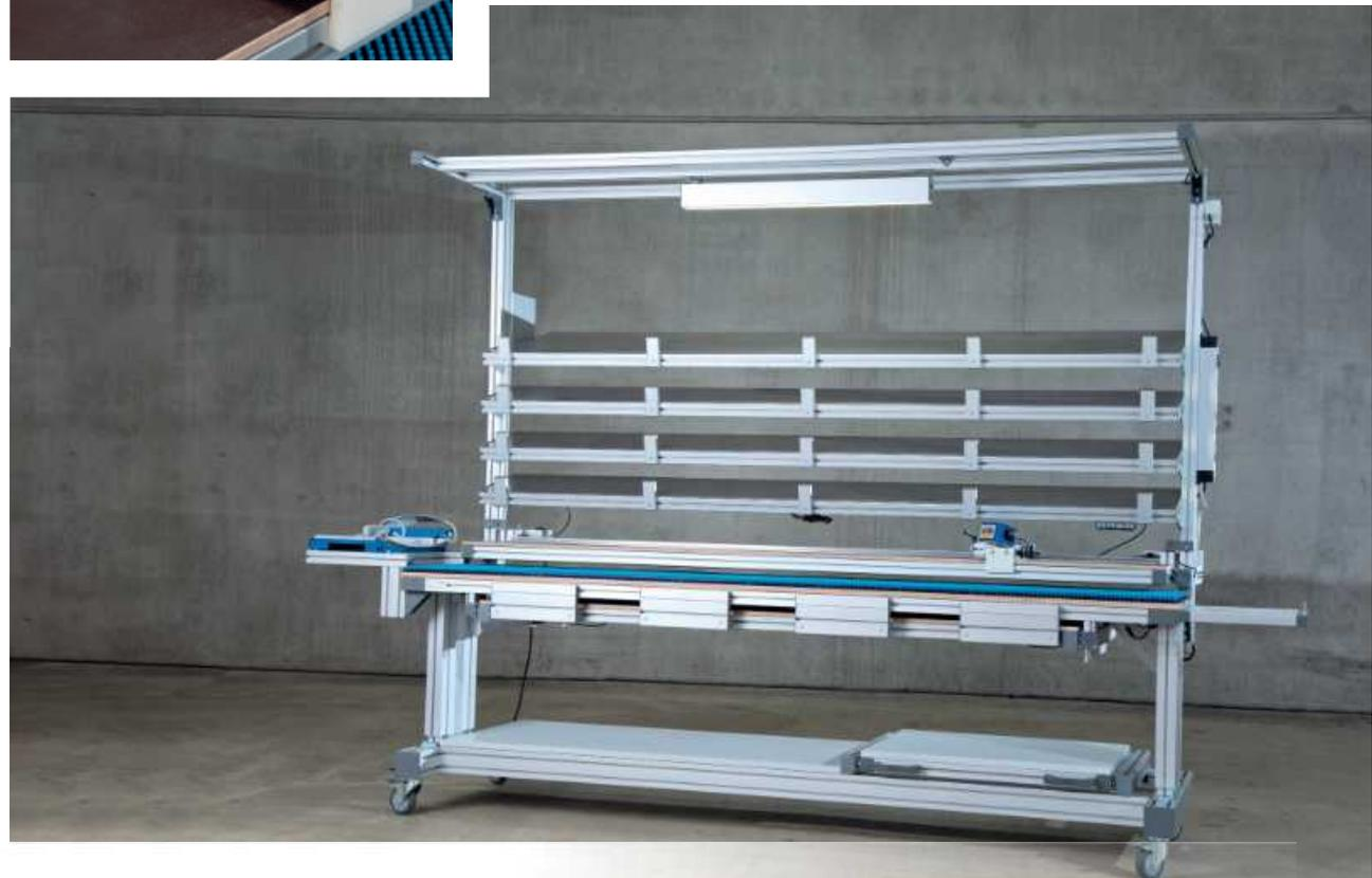
**Ablängstation für Folien mit Verpackstation**
