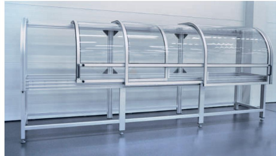
**Schutzeinhausung für Prüfstand**
