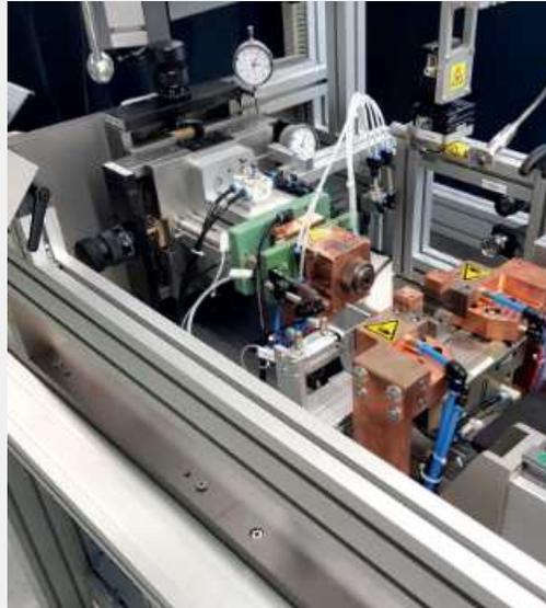
Arbeitsplatz zum Schutzgaslöten von Hartmetallbohrern mit einem Vollhartmetallkopf; das Löten erfolgt ohne die Zugabe eines Lotes.
