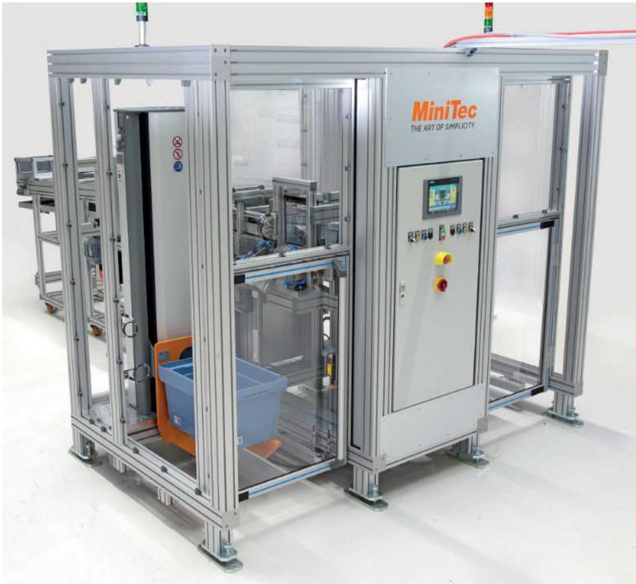
**Anlage zum vollautomatischen Befüllen von Boxen**
