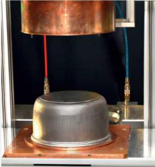
Arbeitsplatz zum Löten von Ronden aus Stahl an Kochtöpfe aus Stahl mit dem Lotwerkstoff L CuMn 12 Ni 2; durch den Einsatz ferritischen Rondenstahls eignet sich der Topf für den Induktionsherd.
