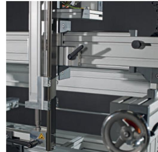
Das Handlingsystem ist konzipiert zur automatischen Entnahme von Glasflaschen aus Pappkartons. Vom Gliederkettenförderer aus erfolgt die Übergabe an die nachgelagerte Maschine.
