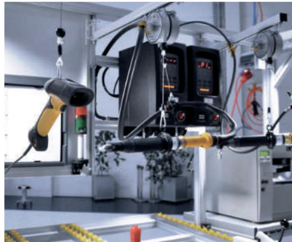
Manuelle Schraubstation mit Bauteilaufnahme
