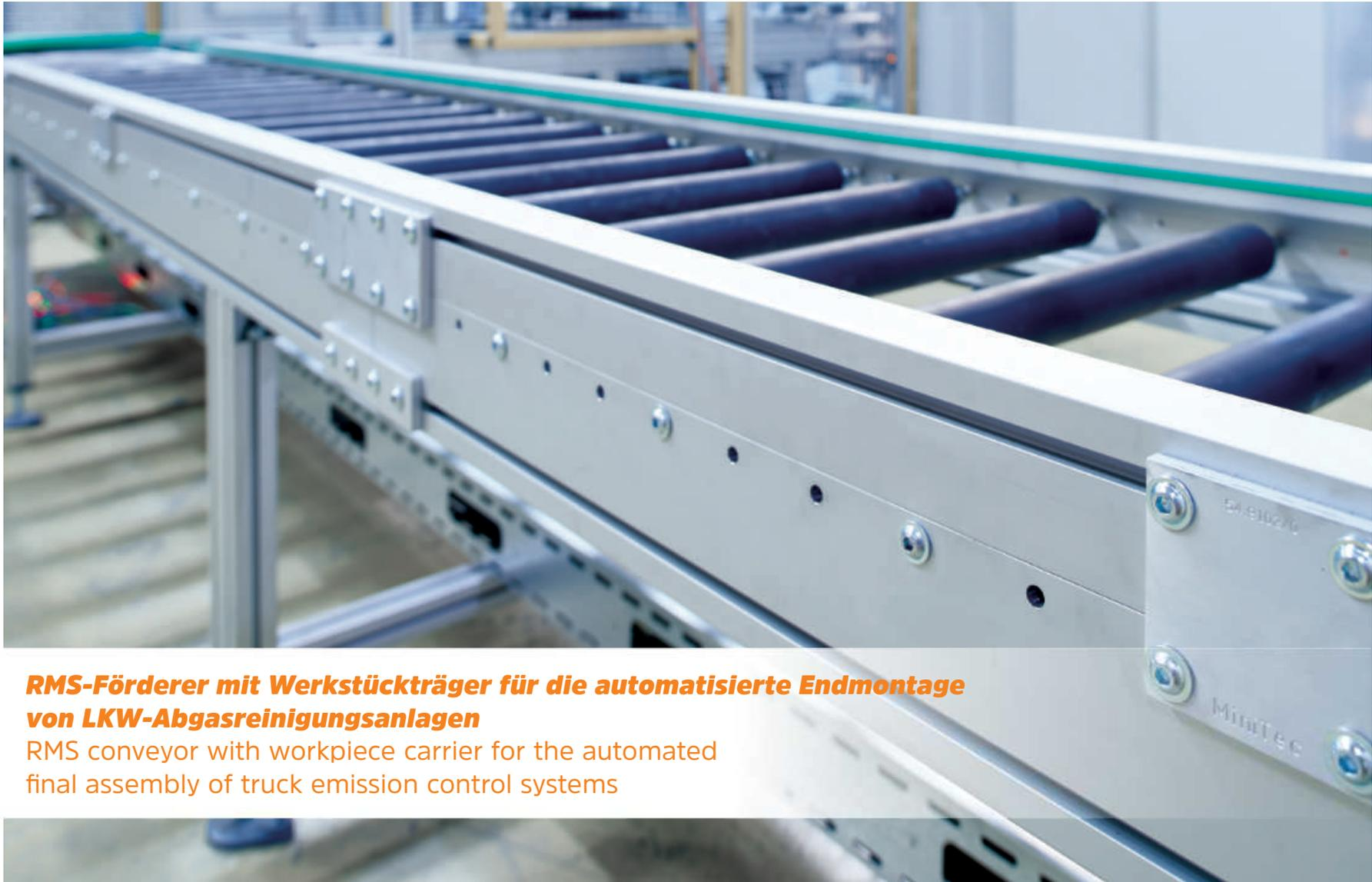
***RMS-Förderer mit Werkstückträger für die automatisierte Endmontage von LKW-Abgasreinigungsanlagen***
