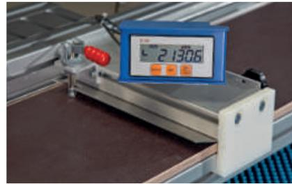
Integrierte Schneidvorrichtung sowie Messsystem
