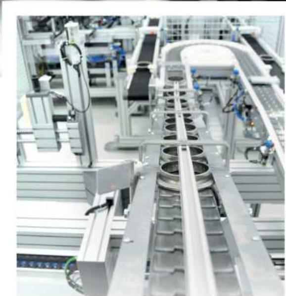
Prüfanlage für Flanschringe inkl. Handlingsystem, Zu- und Abtransport, Vereinzelung, elektrischer und optischer Prüfung der Werkstücke sowie Abstands- und Höhenkontrolle.
