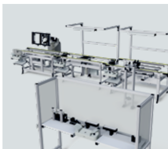
Montažna linija za fotovoltaične module z napravo za spajanje okvirjev
